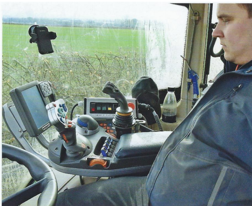
Der Ausleger Twiga Orbital wird über einen extra Joystick (im Bildhintergrund) gesteuert. Die Bedienung der Astsäge LRS 2002 gelingt über Taster, die Teil der Fendt-Ausstattung in der Armlehne sind.
