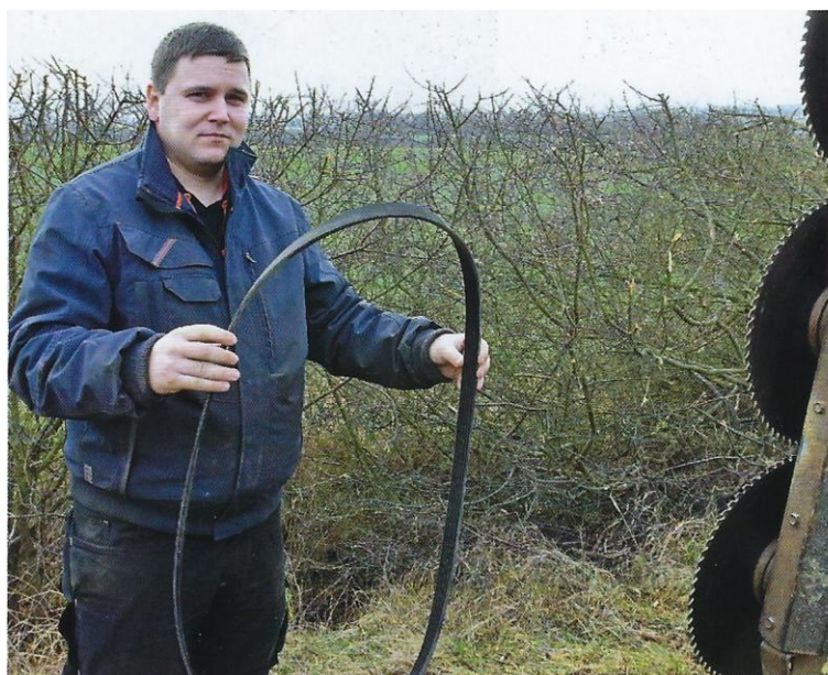
Der Fahrer des Fendt Vario Tobias Spandau mit einem der Powerriemen, die die Sägeblätter antreiben.
